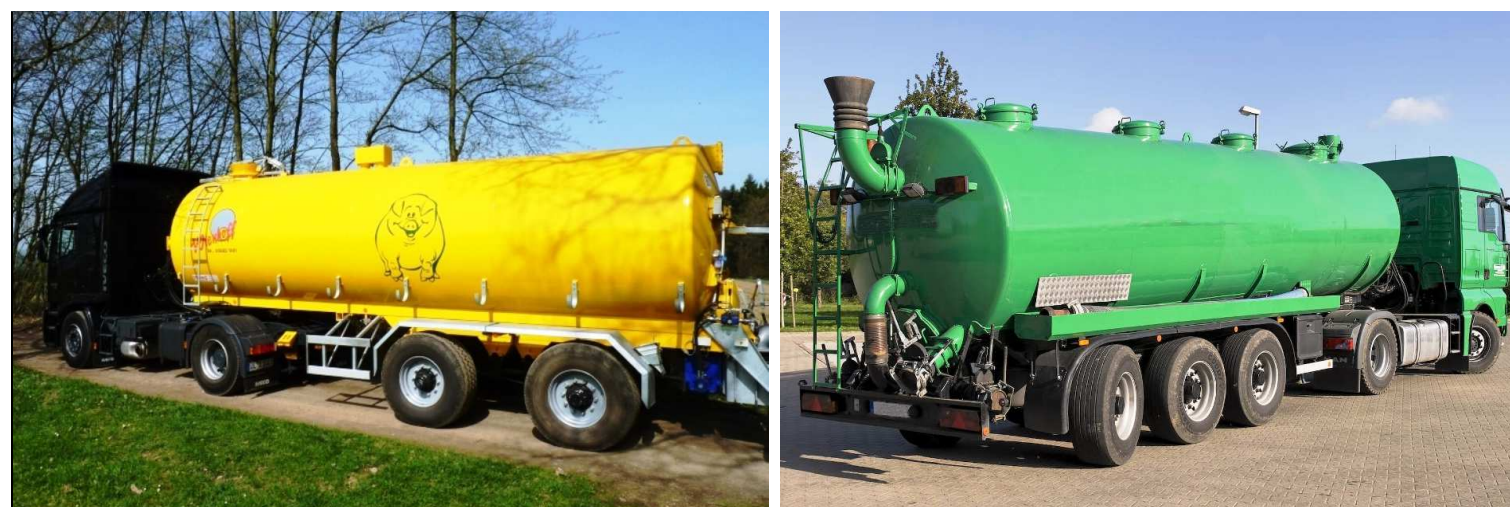
27.000 l čerpadlová cisterna - dvouosý sedlový návěs se stabilizátorem řízení.
