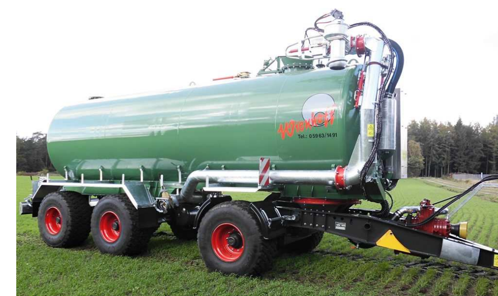
25.000 l vakuová cisterna Tridem s 8" sacím chobotem + plnicí turbínou. Připojovací trychtýř vzadu vlevo. Pneu 560/60 R 22.5
