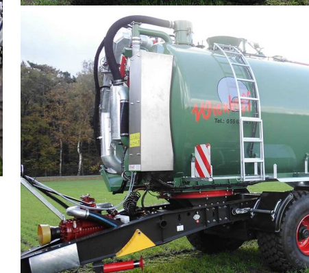
25.000 l vakuová cisterna Tridem s 8" sacím chobotem + plnicí turbínou. Připojovací trychtýř vzadu vlevo. Pneu 560/60 R 22.5
