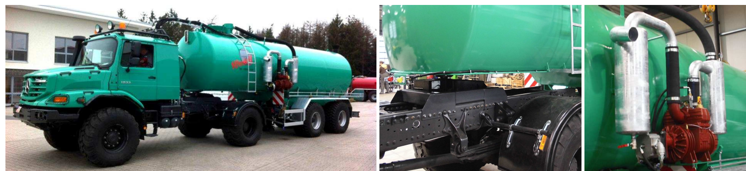
Mercedes Benz Zetros s cisternovou nástavbou 24.000 l a kulovým spojením K150. Schválení 60 km/hod. Kompresor 14.400 l/min. s hydr. pohonem a hydr. plnicí turbínou
