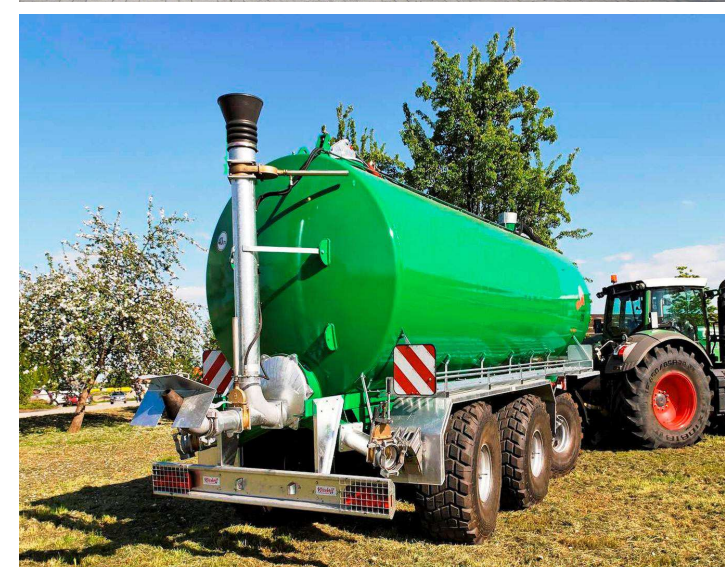
28.000 l vakuová cisterna s Dolly systémem s pneu. 24R 20.5 XS
