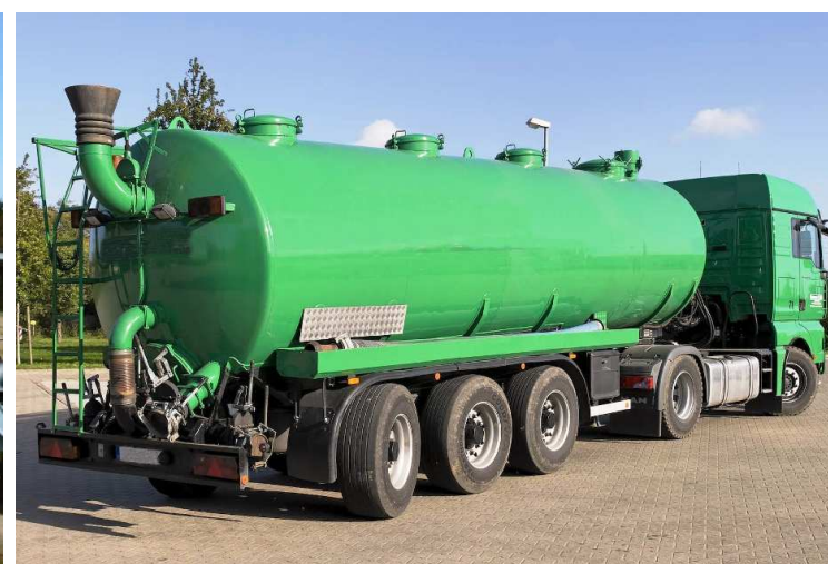
28.500 l vakuová cisterna jako sedlový návěs s plnicí turbínou a míchacím zařízením.
