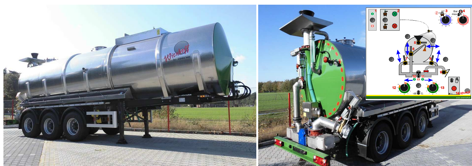
30.000 l V2A cisterna - sedlový návěs s řízenou a zvedací nápravou, míchací zařízení, 8" připojovací trychtýř a nové proporcionální řízení čerpacího zařízení.
